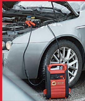
**Sie haben keine elektrischen Stromverbraucher angelassen.** Nach Starthilfe und Aufladen der Batterie verliert diese schnell wieder an Leistung. Batterie ist wahrscheinlich defekt und muss getauscht werden. PS: Ein Batterietest in der Werkstätte Ihres Vertrauens gibt gesichert Auskunft über den Zustand der Batterie und die KFZ-Elektrik (z.B. Reglerspannung).
