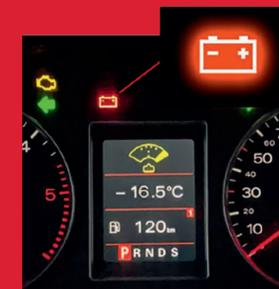
**Keilriemen quietscht und die Lichtmaschine kann dadurch nicht die volle Leistung erbringen.** Keilriemen spannen bzw. erneuern, dabei die Lichtmaschine auf Leichtgängigkeit prüfen. In den meisten Fällen wird dies durch einen Fachmann in der Werkstätte erledigt.
